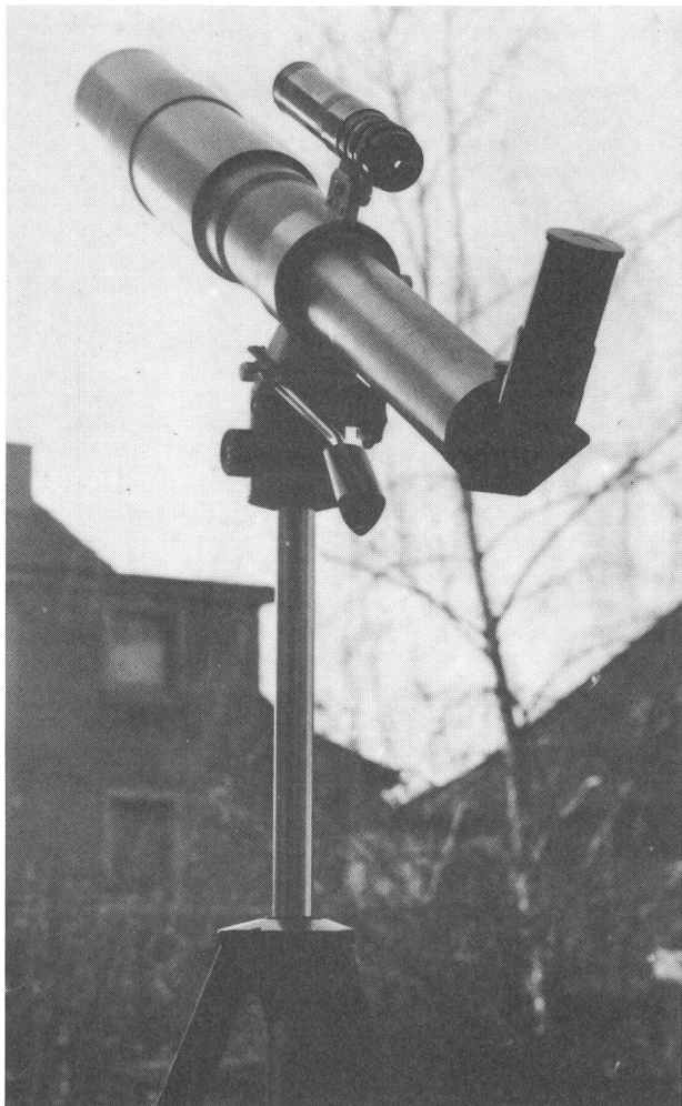
Das Teleskop einsatzbereit auf dem Stativ. Es wiegt einschliesslich Koffer, Stativ und Zubehör nur knapp 6 kg.
