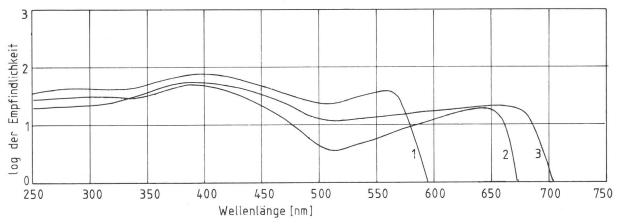
Fig. 2: Das Diagramm zeigt die Kurven der spektralen Empfindlichkeit der drei spektroskopischen Emulsionen Kodak 103a-G (1), 103a-E (2) und 103-F (3). Die Kurven sind für eine Schwärzung, die um 0,6 Skalenteile über der Dichte des Grauschleiers liegt, gezeichnet. Bei den Messungen betrug die Belichtungszeit 1/10 Sekunde; Entwicklung 4 Minuten in D-19 bei 20°C. Beim Film 103-F war die Belichtungszeit 1/25 Sekunde<sup>11</sup>).
