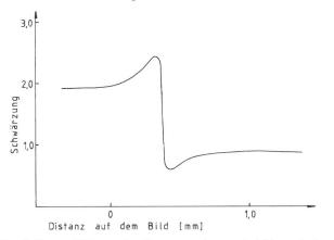
Fig. 5: Kanten-Effekt an der Grenze zwischen zwei gleichmässig beleuchteten Flächen grosser Ausdehnung<sup>14</sup>).
