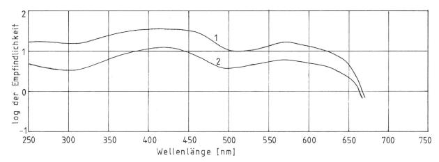
Fig. 3: Kurve der spektralen Empfindlichkeit von Kodak Tri-X Panchromatic Plate, Type B. Kurve 1 gilt für eine Schwärzung von 0,3, Kurve 2 für eine Schwärzung von 0,6 über der Dichte des Grauschleiers. Belichtungszeit 1/25 Sekunde; Entwicklung 4 Minuten in D-19 bei 20°C, die Form der Kurve ist charakteristisch für die meisten panchromatischen Emulsionen<sup>12</sup>).
