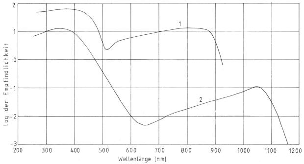
Fig. 4: Spektrale Empfindlichkeit von zwei infrarotempfindlichen Emulsionen. Es handelt sich um Kodak High Speed Infrared Film 4143 (Estar Thick Base), (Kurve 1) und um Kodak Spectroscopic Plate, Type I-Z (hypersensitized), (Kurve 2). Ohne spezielle Behandlung vor der Belichtung wäre der zweite Film viel weniger empfindlich. Die Belichtungszeiten betrugen 1,4 Sekunden, Film 1 ist 8 Minuten in D-76 entwickelt (20°C), Film 2 4 Minuten in D-19 bei gleicher Temperatur.
