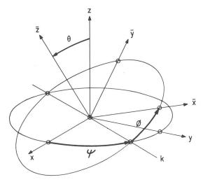
Fig. 2: Die Koordinatensysteme K und K mit den Eulerschen Winkeln.
