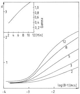
Fig. 11: Schwärzungskurve für Kodak 2475 Recording/Estar Film. Entwickelt in DK 50 bei 20°C. Belichtung 1/50 Sekunde mit Tageslicht. Für längere Belichtungszeiten verliert der Film deutlich an Empfindlichkeit. Folgende Tabelle zeigt den Blendenausgleich:
