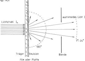
Fig. 2: Vorrichtung für die Messung der Dichte d. Der Film wird mit einem parallelen Lichtstrahl durchleuchtet. Dabei wird ein Teil des Lichtes gestreut. Für die Ermittlung der sogenannten diffusen Dichte wird das gesamte austretende Licht über einen Winkel von 180° berücksichtigt, für die halbdiffuse Dichte ein Winkel von 24° und für die Messung der parallelen Dichte darf nur ein um 7° divergentes Lichtbündel in die Photozelle gelangen.
