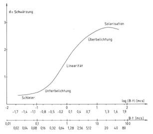
Fig. 1: Beispiel einer Schwärzungskurve. Zur Verdeutlichung des Helligkeitsumfanges sind auf einer zweiten Abszisse neben den Logarithmen auch die Werte für die Belichtung selbst aufgetragen. Masseinheit ist die Meter-Kerzen-Sekunde [mcs]. Die Schwärzung des Films, abgetragen auf der Ordinate, ist als logarithmischer Wert definiert. Sie kann direkt aus der Skala abgelesen werden.
