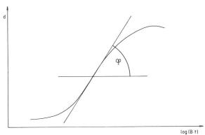
Fig. 3: Der Kontrast Gamma ist als die grösste Steigung der Schwärzungskurve definiert. Er wird als Tangens des Winkels  $\varphi$  angegeben. Der Gamma-Wert ermöglicht keine Rückschlüsse auf die allgemeine Form der Kurve, da für ihn nur der Punkt grösster Steigung massgebend ist.
