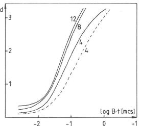
Fig. 9: Schwärzungskurven für die Filme Kodak 103a-O (gestrichelte Linie) und Kodak 103a-F (ausgezogene Linien). Die Zahlen bei den Kurven sind die Entwicklungszeiten im Entwickler D 19 bei 20°C.
