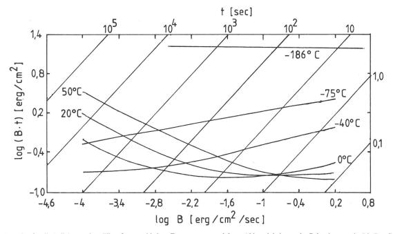
Fig. 8: Energien für die Belichtung eines Films für verschiedene Temperaturen und deren Abhängigkeit von der Beleuchtungszeit. Die Empfindlichkeit bei langen Belichtungszeiten nimmt mit sinkenden Temperaturen zuerst zu, dann wieder ab<sup>s</sup>).
