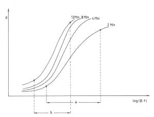
Fig. 4: Änderung der Schwärzungskurve während der Entwicklung des Films. Die Zahlen bei den Kurven bedeuten die Entwicklungszeiten. Bei gesteigerter Entwicklung des Films nimmt der brauchbare Belichtungsspielraum ab. Man beachte, dass a und b auf einer logarithmischen Skala abgetragen sind. Der Belichtungsspielraum a ist viermal grösser als b.
