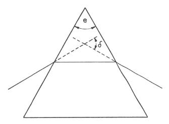
Fig. 2: Minimum der Ablenkung.
