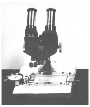
Fig. 4: Gerät zur Mikrometervermessung.
