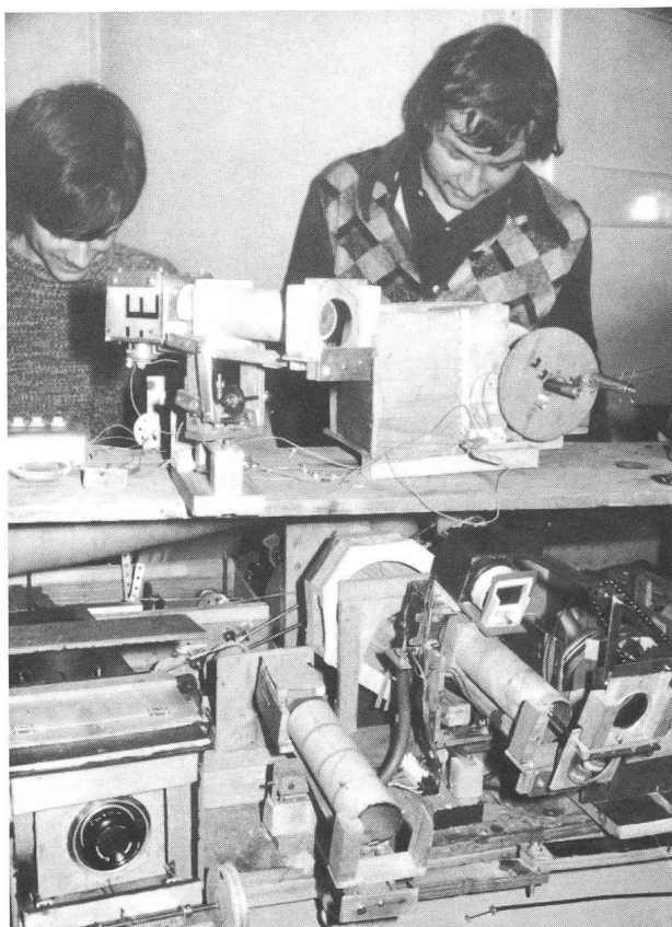
Abb. 1: Die beiden Erbauer des Planetariums hinter dem Gerät. Von hier aus wird die ganze Anlage gesteuert und auf eine Leinwand von 5 \times 3,2 m projiziert.
