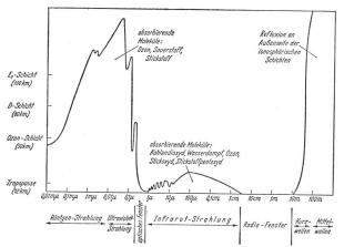
Absorptionshöhe für verschiedene Wellenlängen. Aus der Kurve ist die mittlere Höhe abzulesen, in der die Strahlung mit entsprechender Wellenlänge absorbiert wird. Unsere Atmosphäre ist lediglich für Strahlung mit einer Wellenlänge um 0,5 Mikron (Optisches Fenster) und einem Wellenlängenintervall zwischen 1 cm und 10 m durchlässig.
