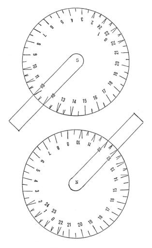
Abb. 2: Das Süd- und Nordzifferblatt. Letzteres ist das im Uhrzeigersinn numerierte.
