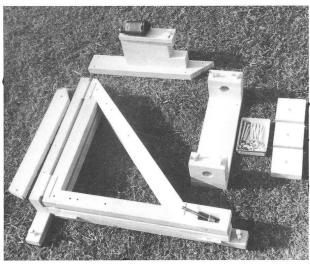
Fig. 5: Montierung zerlegt und zusammengeklappt. Oben Sucher, links Unterlagebretter und Halterung für Fotostativ-Oberteil.
