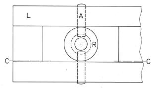
Fig. 1: Die Bauteile für die Nachführung. Unten: Lattenende mit eingebautem Ring (Aufsicht). Oben: Schnitt C-C, mit Schraube und Bodenbrett. Weitere Erklärungen im Text.
