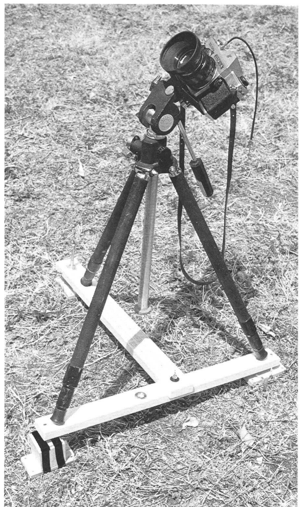
Fig. 3: So wurde der Latten-Unterbau im Mombasa verwendet. Beim südlichen Ende (links) die Holzunterlagen (entsprechend 4° südl. Breite), beim westlichen Ende (hinten) die Nachführschraube.
