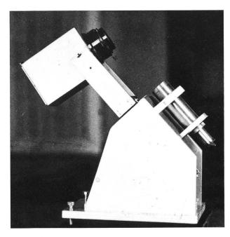
Fig. 2: Mini-Astrograph mit 6x9-Plattenkamera. Rechts ist das Justierfernrohr zu sehen.
