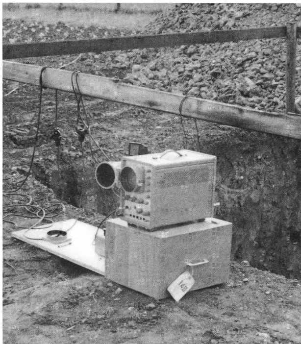
Fig. 2: Um nicht durch unerwartete Bodenerschütterungen durch die 200 m entfernte Bahnlinie überrascht zu werden, wurden ausführliche Vorabklärungen unternommen.
