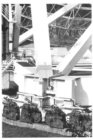
Abb. 4: Eines der 4 Azimutfahrwerke des Teleskops. Einen Grössenvergleich bietet der Arbeiter links am Treppenaufgang.
