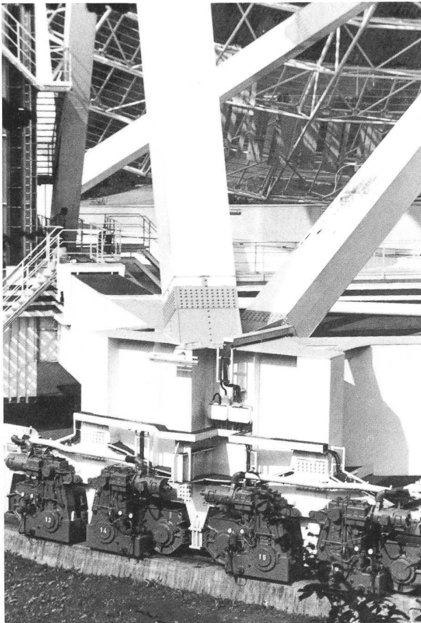
Abb. 4: Eines der 4 Azimutfahrwerke des Teleskops. Einen Grössenvergleich bietet der Arbeiter links am Treppenaufgang. Alle Abbildungen: Aufnahmen des Verfassers.
