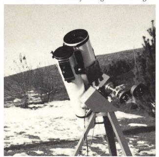
konstanz und Steifheit des Zusammenbaues zu erreichen, sind die beiden grossen Stützringe zusätzlich zur Rohrbefestigung noch durch drei Stahlrohre Ø 10/5 mm miteinander fest verbunden. Gleichzeitig bleibt durch diese Massnahme die Optik bei einem eventuellen späteren Ausbau aus dem Rohr beisammen und somit die Justierung erhalten. Als Rohr wurde das bei der Materialzentrale beziehbare Dellitrohr Ø 240/248 mm verwendet, das bei geringem Gewicht eine hohe Steiffigkeit aufweist.
