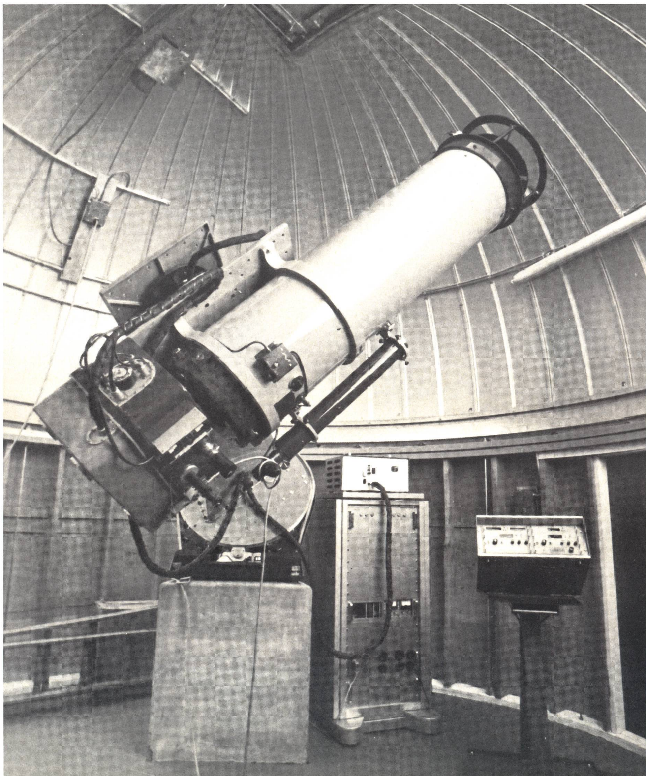
Fig. 4: Le télescope de 40 cm avec le photomètre photoélectrique destiné aux observations en sept couleurs UBVB 1 B 1 V 2 G de la photométrie de Genève. A droite la console de commande où s'affichent les coordonnées \alpha et \delta de l'objet visé.
