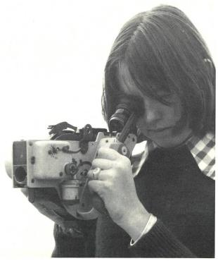
Fig. 1: Das Stern- oder Sonnenlicht fällt von links oben auf einen unter dem Okular befindlichen Spiegel, der mit Hilfe eines grossen, mit Teilung versehenden Drehknopfes bewegt werden kann. Der Spiegel ist halbdurchlässig und gestattet gleichzeitig den Blick auf die im vorderen Teil des Apparates befindliche Dosenlibelle.
