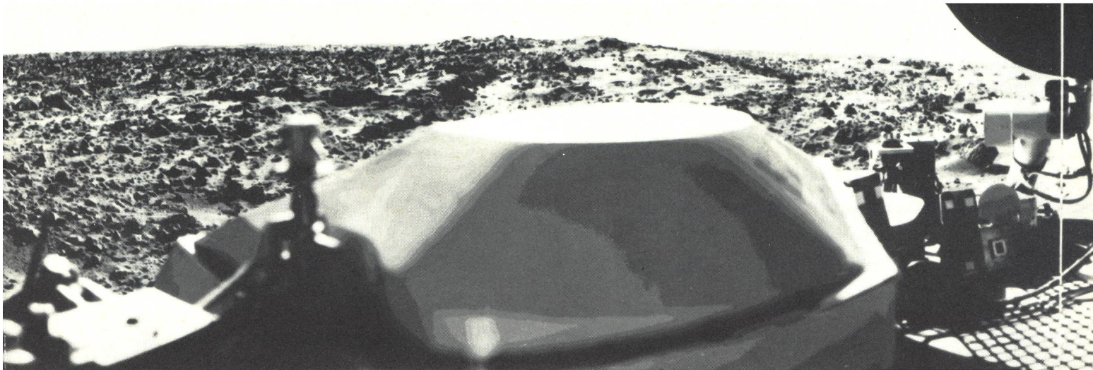
beherbergt den noch zusammengeklappten 3 m langen Schürfarm. Ganz rechts im Panoramabild ist die 75 cm S-Band-Parabolantenne der Sendeanlage zu sehen. Die drei kleinen Quadrate auf der dunklen Fläche darunter sind Dauermagnete zur Feststellung magnetischer Staubpartikel. Dieses Panoramabild entstand am späten Mars-Nachmittag. Die Sonne steht tief im Westen, etwa über der Mitte der rechten Bildhälfte. (NASA, Viking 1-45)
