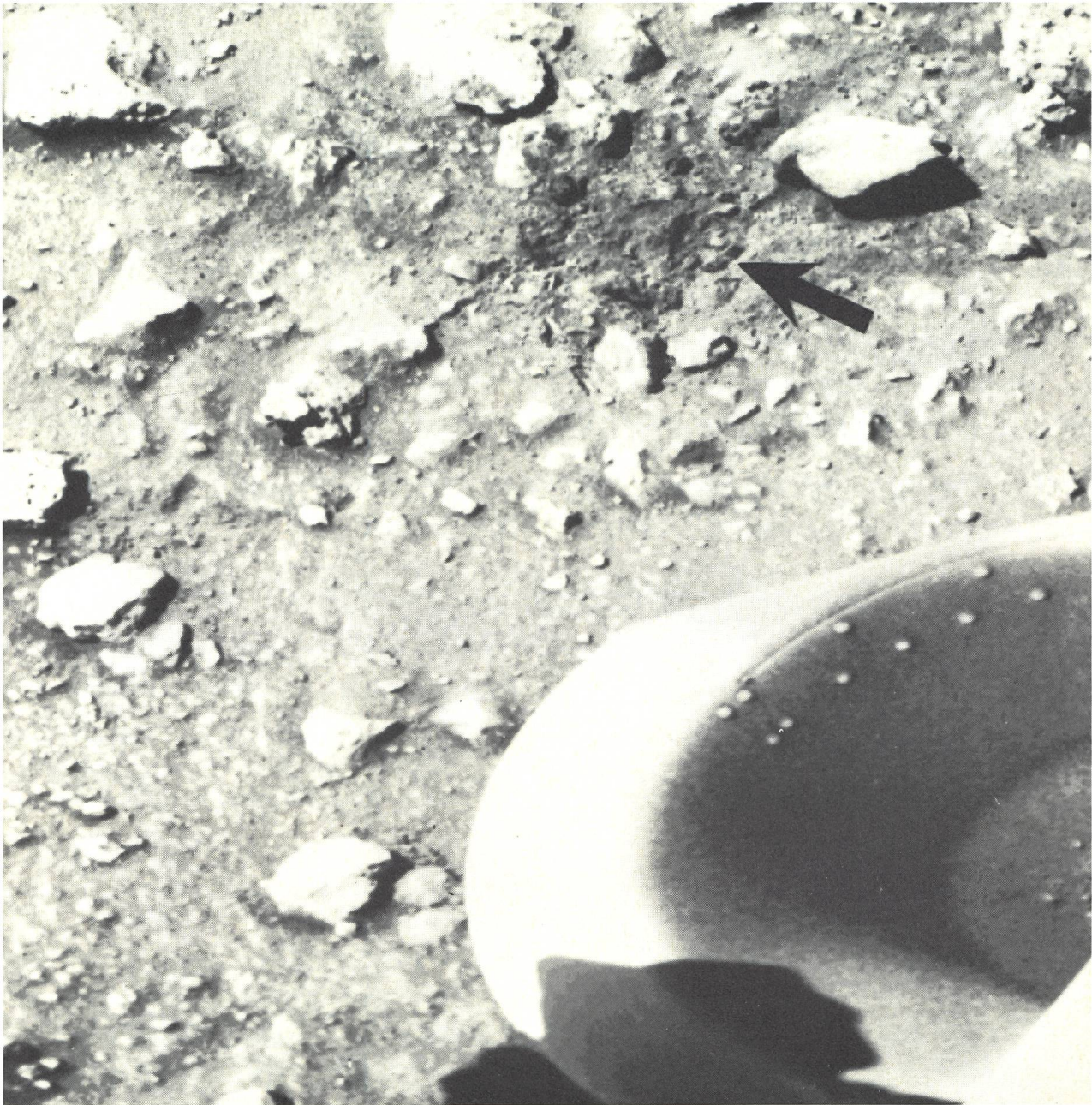
Fig. 12: Der dunkle Fleck in der oberen Bildhälfte (Pfeil) stammt vom Aufprall des Schutzdeckels des Schaufelarms. Der Schutzdeckel selbst ist nicht mehr sichtbar. Vergleiche Fig. 10. (NASA, Viking 1-47)
