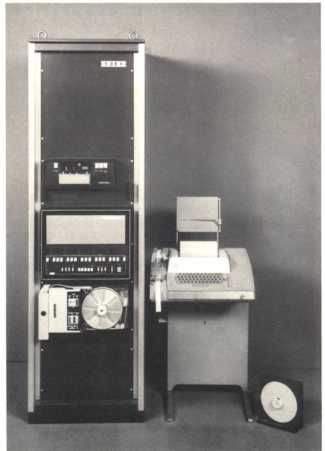
Fig. 3: Der Prozess-Rechner mit Teletype zur Steuerung des 2,20 m- Zeiss Teleskops. Der Rechner übernimmt auch die Antriebsbefehle für die Kuppel und den Windschirm.
