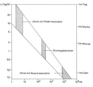
Fig. 2: Prinzipielle Abhängigkeit der Ganggenauigkeit von der Frequenz des benützten Schwingers.
