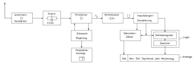
Fig. 3: Blockschaltbild des Zeitzeichenempfängers mit Decodierung und kompletter Digitalanzeige.
