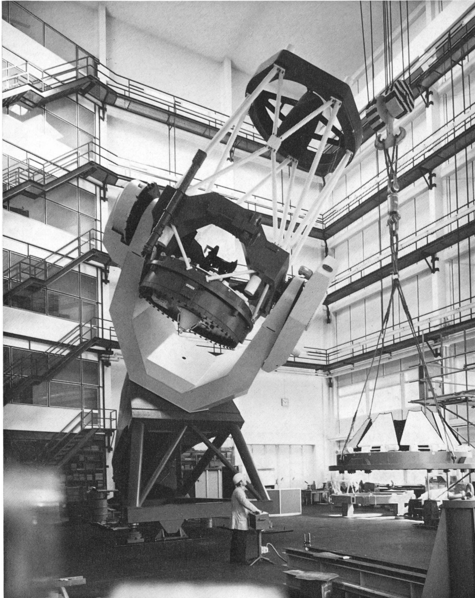
Abb. 6: Das 2.20 m-Zeiss-RC-Teleskop für Calar Alto beim Werksaufbau in der grossen Montagehalle von Carl Zeiss, Oberkochen. Deutlich ist die zusätzliche Verknotung im Gittertubus (vorne) zu sehen, die notwendig ist, um den neuartigen Strahlengang des CouDé-Lichtbündels zu ermöglichen. Werkphoto: Carl Zeiss, Oberkochen.
