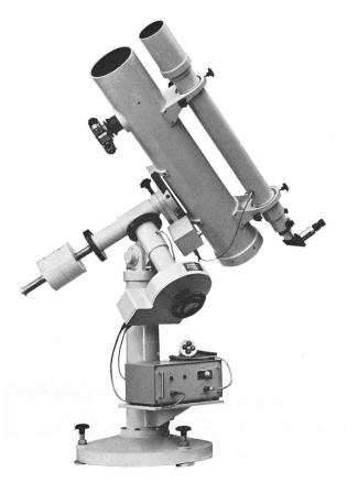
Fig. 3: Beispiel eines astrofotografischen Newton-Teleskopes 150 mm Diameter, bei dem u. a. die in dieser Mitteilung angegebenen Voraussetzungen erfüllt sind. (Bauart E. Alt).
