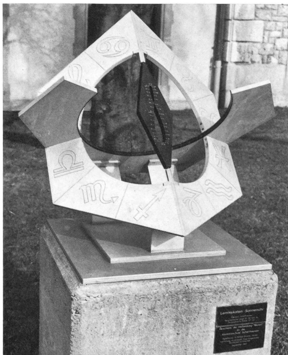
Abb. 3: Lemniskaten-Sonnenuhr im Hof der Kantonsschule Schaffhausen auf dem Munot-Plateau. Geschenk der Verbindung «Munot» an die Kantonsschule. Für 8^{\circ}39' geogr. Länge und 47^{\circ}42' geogr. Breite berechnet vom Verfasser und ausgeführt vom Forschungsinstitut der Alusuisse in Neuhausen/Rheinfall. Links : Frontansicht; rechts : Seitenansicht von Osten zur Sichtbarmachung der Stundenteilungen in MEZ und WOZ.
