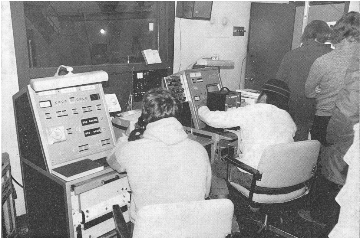
Fig. 4: Blick in den Kontrollraum des 2.24 m-Spiegelteleskops mit den Steuerpulten. Die Bewegungen des Teleskops können vom Bedienungspersonal durch die Glasscheibe links im Hintergrund des Bildes verfolgt werden.
