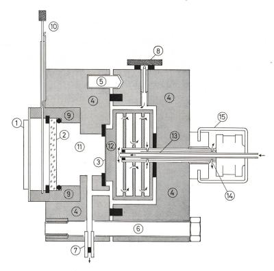
Fig. 1: Prinzipieller Schnitt durch die Tiefkühlkammer des Verfassers.
