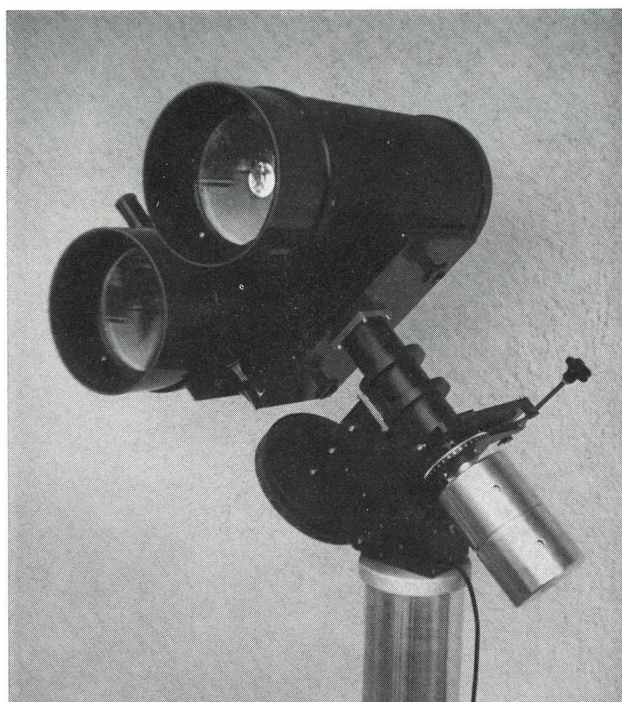
MAKSUTOW-Doppel-Teleskop 200/500 mm und 3200 mm
