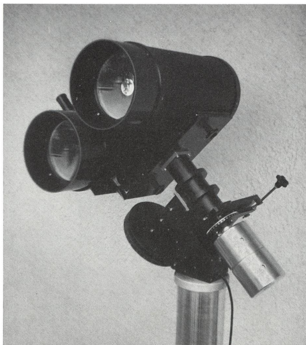
MAKSUTOW-Doppel-Teleskop 200/500 mm und 3200 mm
