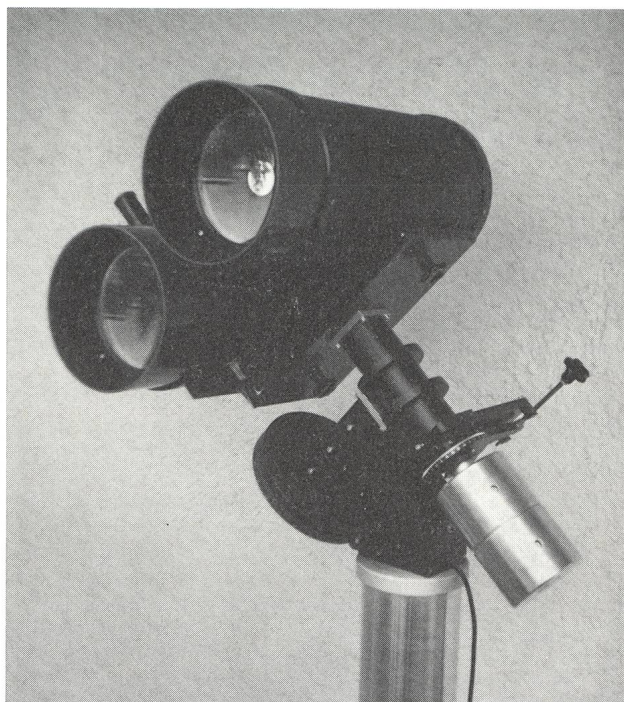
MAKSUTOW-Doppel-Teleskop 200/500 mm und 3200 mm
