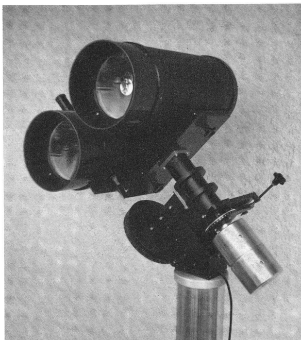
MAKSUTOW-Doppel-Teleskop 200/500 mm und 3200 mm
