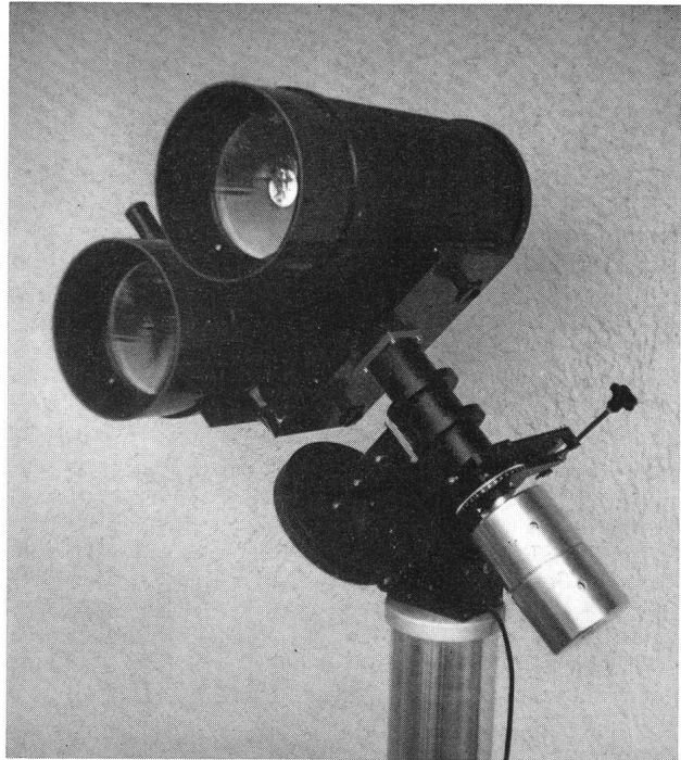
MAKSUTOW-Doppel-Teleskop 200/500 mm und 3200 mm
