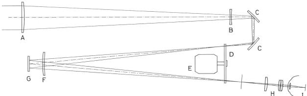
Schematische Abbildung des beschriebenen gefalteten Spektrohelioskops.
