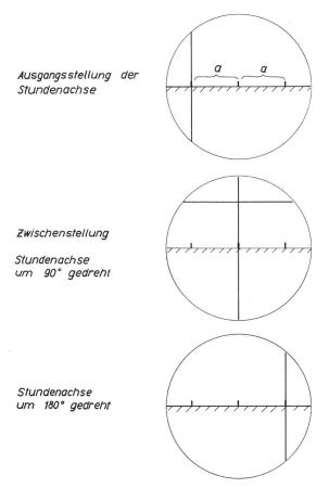
Abb. 3: Anblick im Justierfernrohr bei richtig justiertem Prisma
