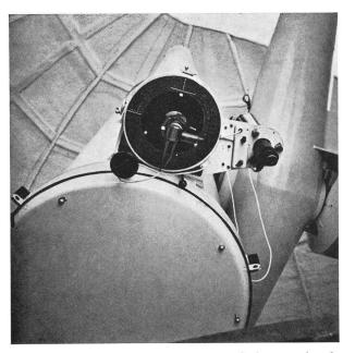
Fig. 5: Vue partielle de l'instrument – On distingue au bas de la lunette-guide (en haut et à gauche) les deux manivelles commandant actuellement le déplacement de la platine du porte – oculaire.
