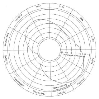
Fig. 1. Kurve der Zeitgleichung im Polarkoordinatensystem. Gleichzeitig Einstellskala auf der Frontplatte<sup>1</sup>).
