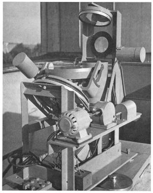
Bild 4: Der Heliostat des Turmteleskops.
