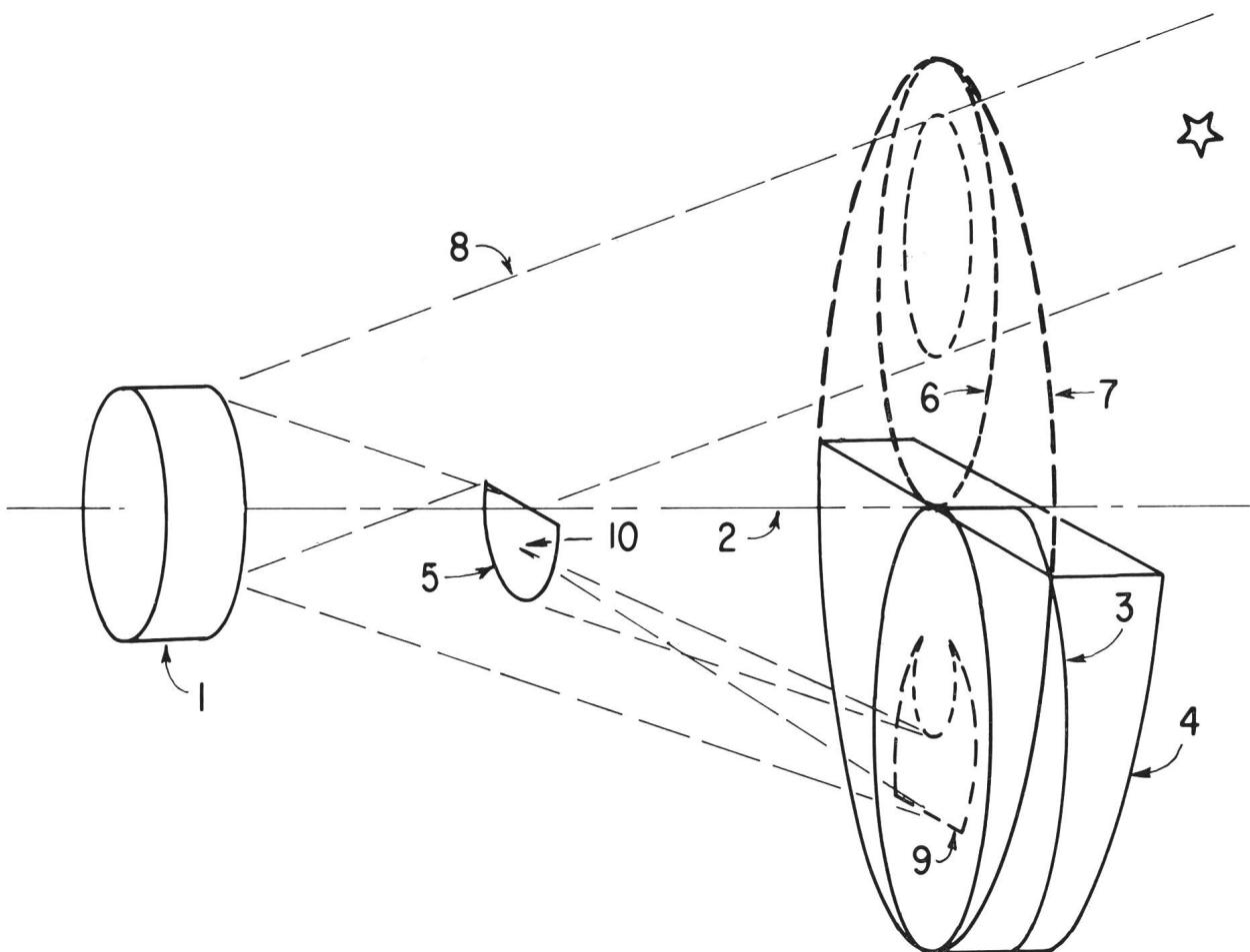
*Geometrische Verbesserung der Reflexions-Schmidt-Kamera.* Die eingezeichneten Ziffern bedeuten: 1 = Schmidt-Korrektions-Plattenspiegel; 2 = optische Achse des Korrektions-Plattenspiegels; 3 = kreisförmig begrenzter Kugel-Spiegel des Prototyps; 4 = vorgeschlagener halbkreisförmig begrenzter Kugel-Spiegel; 5 = halbkreisförmiger Film in der Fokalfläche; 6 = Gesichtsfeld beim Prototyp mit dem kreisförmigen Kugel-Spiegel; 7 = Gesichts-
