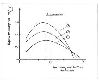
*Abb. 2:* Abhängigkeit der Zugscherfestigkeit vom Mischungsverhältnis und von den Aushärtebedingungen: ① Aushärten bei 20° während 24 Stunden, ② Aushärten bei 100° während 30 Minuten, ③ Aushärten bei 180° während 10 Minuten.
