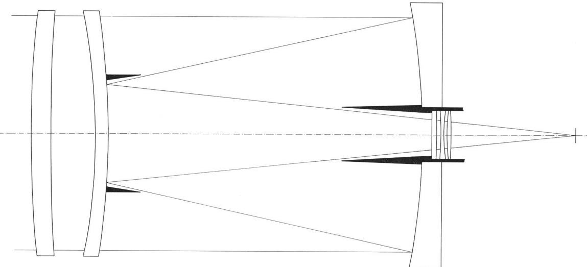
Fig.2 Doppel-Meniskus-System mit Korrektor  $R=1:4,8$   $f=1m$  für die Amateur-Astronomie (Verfasser)
