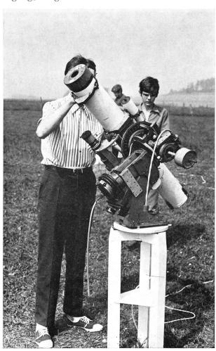
110 mm-Newton-Teleskop mit Nachführung. Fast alle Teile sind aus Holz; der Bau des Fernrohres dauerte ca. ein Jahr.
