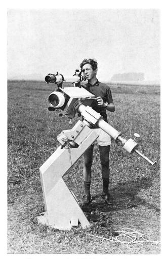
50 mm-Astrograph mit Knicksäulenmontierung.
