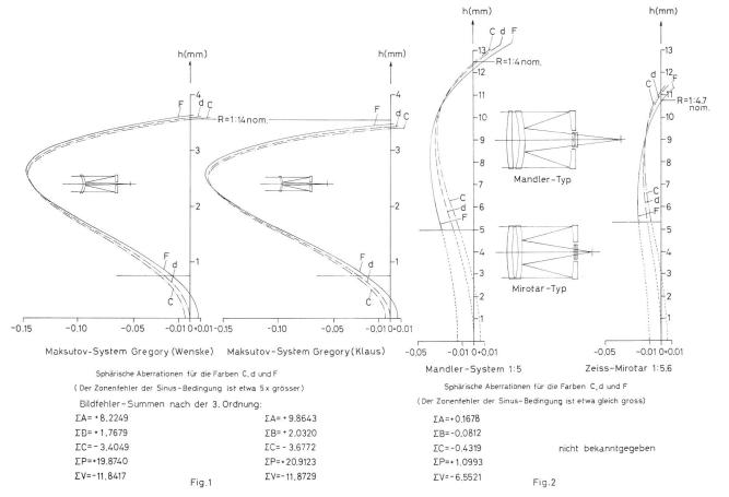
Fig. 1: a) Geradsichtiges Maksutov-System nach J. Gregory<sup>2</sup>). b) Modifiziertes geradsichtiges Maksutov-System. Daten nach G. Klaus<sup>3</sup>).
