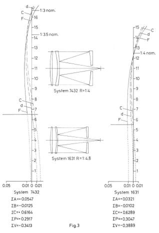
Fig. 3: Zwei Doppel-Meniskus-Systeme R=1:3 und 1:4 (nominell) nach den Rechnungen des Verfassers<sup>9</sup>).
