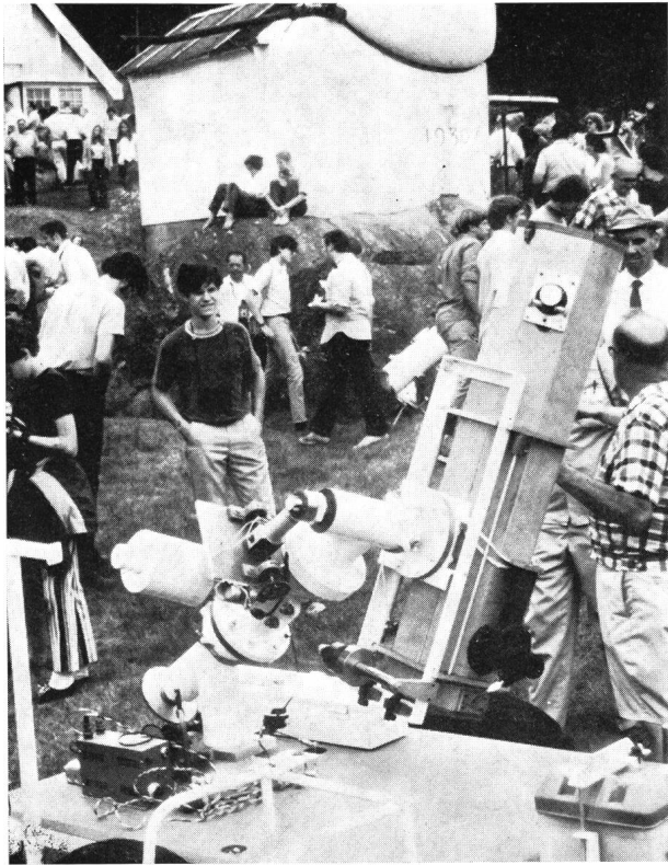
Ein transportierbares Instrument auf einer Plattform, die mit 4 Schrauben justiert werden kann. Im Hintergrund sieht man das berühmte PORTER-Turmteleskop.
