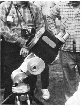
Der beste Refraktor des Jahres: Objektivdurchmesser 12.7 cm, gefalteter Strahlengang, f/5, Eigentümer und Hersteller Adelard Rousseau aus Montreal, Kanada.
