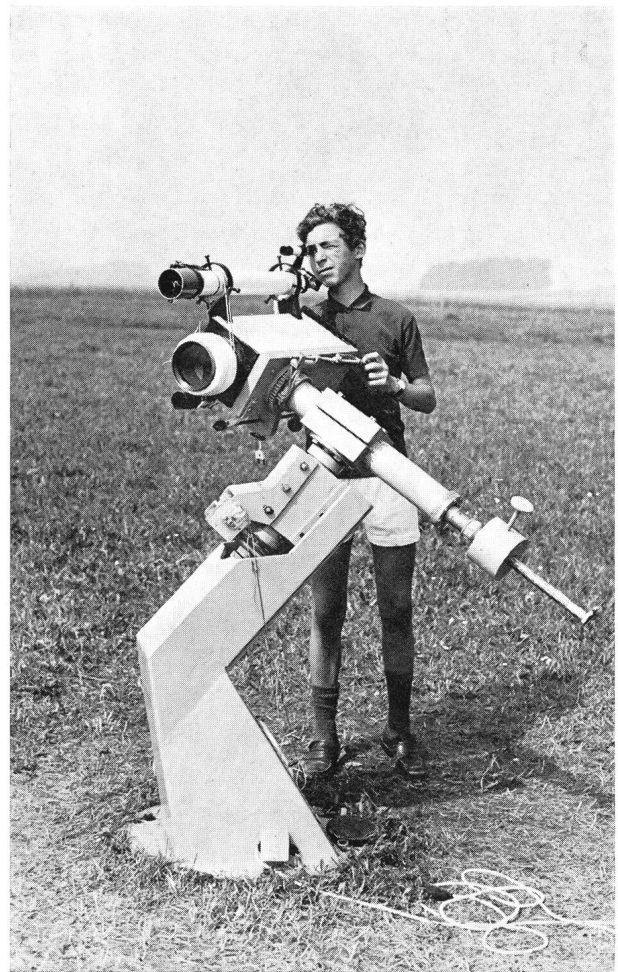
50mm-Astrograph mit Knicksäulenmontierung.
