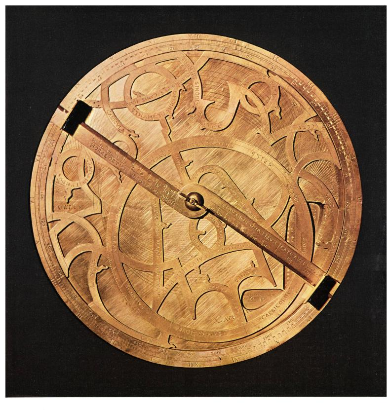
den auch die mit Astrolabien möglichen Höhen- und Feldmessungen beschrieben. Das Astrolabium wird an der Armilla gehalten und pendelt sich in die vertikale Lage ein, man dreht es in die Richtung zum Gestirn, das man durch die erwähnten Absehlöcher der Alhidade anvisiert, und kann dann am Randwulst der Mater den Höhenwinkel ablesen.
