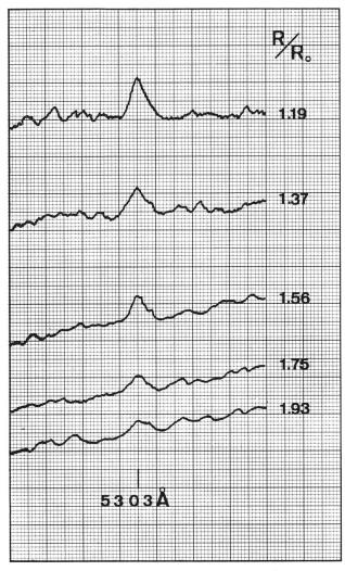
Fig. 1: 50fach vergrösserte photometrische Registrierung einer Spektrographenaufnahme im Gebiet der grünen Linie (Dispersion 200 Å/mm) beim Positionswinkel 105°. Belichtungszeit der Aufnahme: 10 Sekunden. Gradient des Keils: 0.087 d/cm.
