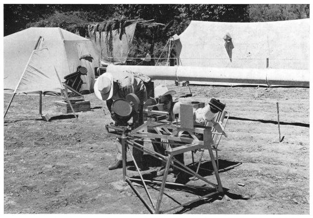
Abb. 1: J. Dürst rechts und F. Aebersold beim Justieren des Spektrographen. Das demontierbare Gestell dient auch als Auflage für den Coleostaten. Im Hintergrund stehen die Lagerzelte.
