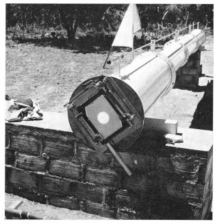
Abb. 3: Kassettenhalterung und Mattscheibe der 8m-Kamera. Das Plattenformat beträgt 18 × 24 cm.
