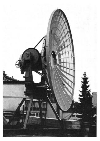
Parabolreflektor des ETH-Radioteleskops ohne Primärstrahler.
