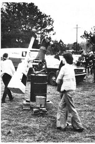
Fig. 1: Le pied est composé de briques et d'un tonneau de goudron avec contrepoids formé d'un seau rempli de limaille de plomb.
