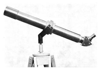
*Abb. 1:* Selbstbau-Fernrohr 50/540 mm mit Polarisations-Sonnen-Okular (beschrieben in «Die Sterne» [1951] S. 161 ff. daselbst auch Beschreibung weiterer Sonnenokulare einschliesslich Penta-Prisma).
