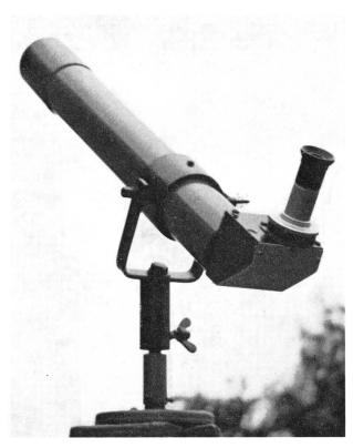
Abb. 4: Zenit-Dachprisma wie erwähnt mit exzentrischer Anordnung zur Vermeidung der Beugung, an einem Fernrohr 50/540 mm.
