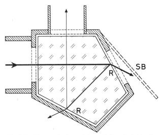
Abb. 5: Strahlengang im Penta-Prisma. Bleiben die beiden Reflexionsflächen unversilbert, ergibt es in Verbindung mit einem schwachen Dämpfglas (Keil!) ein vorzügliches Sonnen-Okular (siehe Text). R= Reflexionsflächen, SB= Schutzblech.
