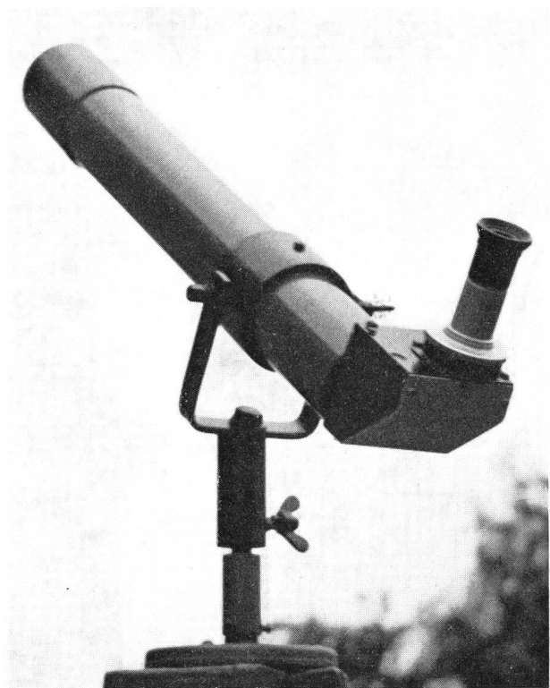
Abb. 4: Zenit-Dachprisma wie erwähnt mit exzentrischer Anordnung zur Vermeidung der Beugung, an einem Fernrohr 50/540 mm.
