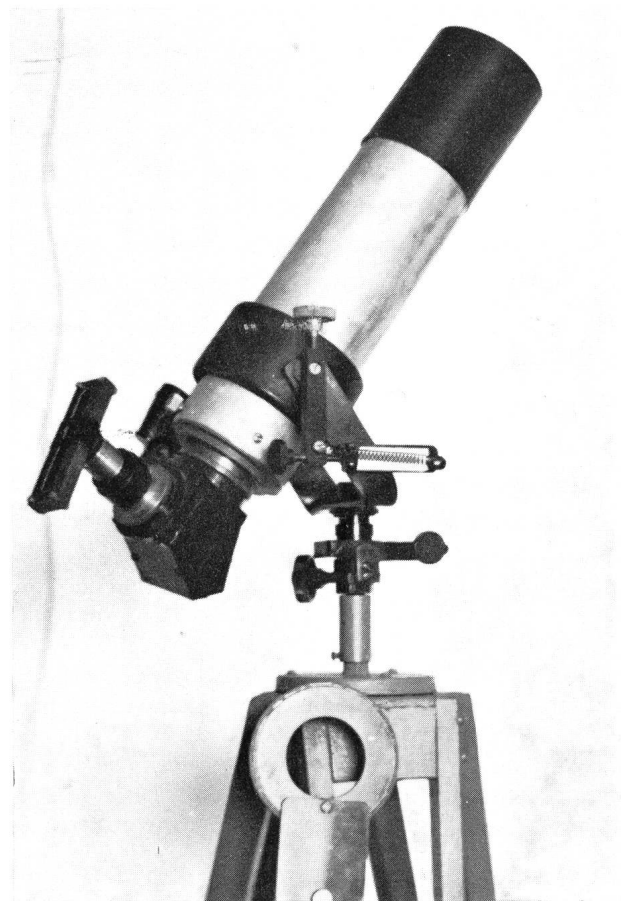
Abb. 3: Selbstbau-Fernrohr 80/500 mit Feinbewegungen in Azimut und Höhe mit Zenit-Penta-Prisma; auf dem Okular der beschriebene Sonnenkeil.
