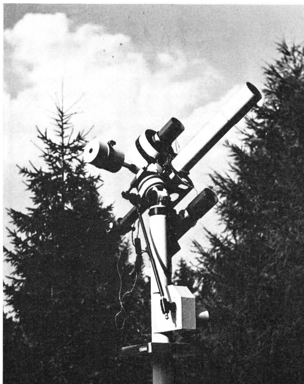
Abb. 11: Expeditions-Fernrohr von Prof. HOFFMEISTER, Leitrohr 63/840 mm auf parallaktischer Montierung mit zwei Tessar-Kameras für Überwachungsaufnahmen am Südhimmel (Aufnahme E. SPLITTGERBER, Halle/S.).
