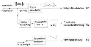
Abb. 4: Blockschema der Empfangs- und Bildreproduktionsanlage.
