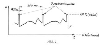
Abtastvorgang nach 200 Sekunden beendet. Das Frequenzspektrum des Videosignals erstreckt sich von 4 bis 1600 Hz. Vor Beginn einer Bildabtastung wird zunächst ein Signal von 300 Hz an die Empfangsstation übermittelt, das die automatischen Bildschreiber anlaufen lässt. Anschliessend folgen einige sogenannte Phasing-Impulse, die negativ gerichtet sind und die die Maschinen synchronisieren sollen. Der modulierte Hilfsträger dient zur Frequenzmodulation des Satellitensenders.
