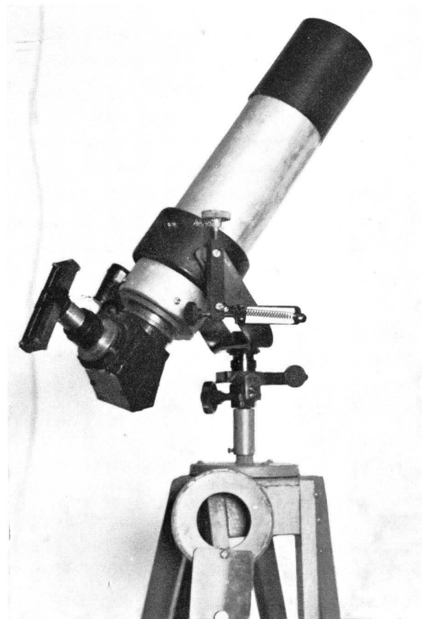
Abb. 3: Selbstbau-Fernrohr 80/500 mit Feinbewegungen in Azimut und Höhe mit Zenit-Penta-Prisma; auf dem Okular der beschriebene Sonnenkeil.
